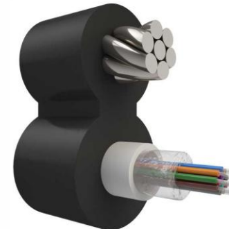
С ЦЕНТРАЛЬНОЙ ТРУБКОЙ И ВЫНОСНЫМ СИЛОВЫМ ЭЛЕМЕНТОМ ИЗ СТАЛЬНОГО ТРОСА
